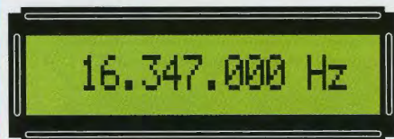
Fig.25 Sapendo che una induttanza da 2,2 microH. con in parallelo una capacità di 33 pF più 10 pF circa di capacità parassita dovrebbe accordarsi sui 16.347.000 Hz, digitate da tastiera questo numero.
