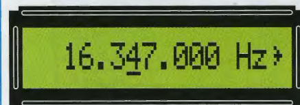
Fig.28 Poichè inizialmente conviene variare la frequenza delle decine di migliaia di Hz, dovete premere il tasto * in modo da sottolineare il numero 4 posto sulla quinta cifra, contando da destra.
